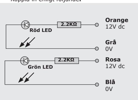
**OBS!** Använd endast 12 Vdc till LED-lamporna.
