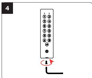
Skruta fast Digicode®-kodlåset med bifogad Diax® monteringsskruv M5x8 och T20 Diax® nyckeln.
