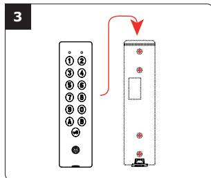
Trä PROFIL100EC-kabeln genom kabelhålet i bakstycket. Kroka fast kodlåset på bakstycket genom att föra det uppifrån och ner.
