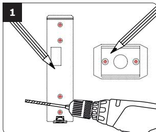
Kontrollera avståndet mellan PROFIL100EC kodlås och styrenhet (Se sid 11 «Information och rekommendationer»). Sätt kodlåsets bakstycke och styrenhetens monteringsplatta mot väggen och markera hålets placering med en penna. Borra sedan två monteringshål och hål för kabeln ( $\varnothing 5$  mm borr och minst 35 mm djupt).
