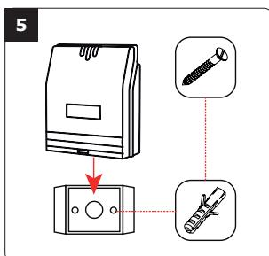
Indsæt de 2 plastikplugs i hullerne. Anbring beslaget til styreenheden på væggen og skru det fast med de medfølgende M4x30 skruer. Skub enheden på beslaget, oppefra og ned.
